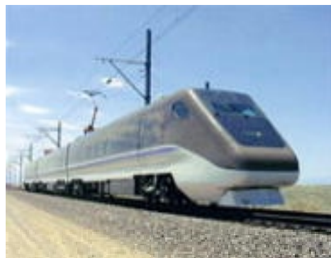
導入が計画されている実験中のフリーゲージトレイン (長崎県のホームページから転載)
